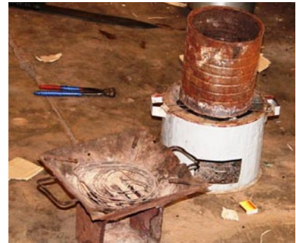
Alte Holzkohlekokern mit hohem Verbrauch...
